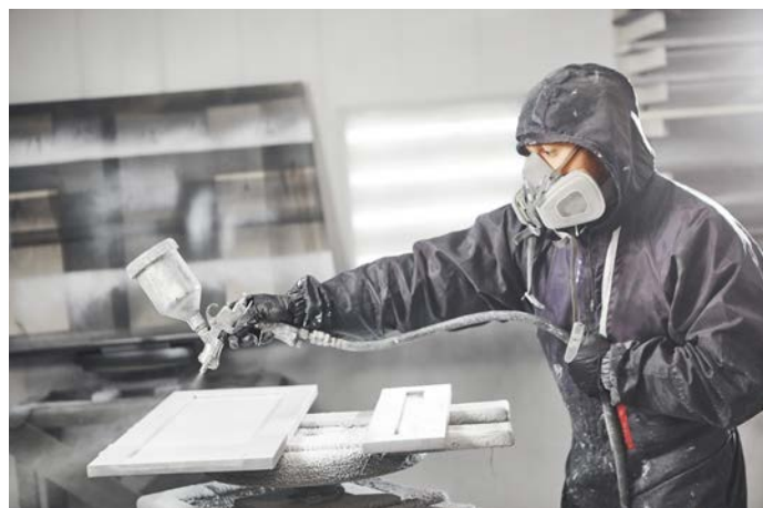
Topcoating von Holzteilen
